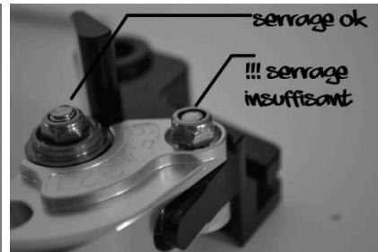
**ATTENTION : CE POINT EST TRES IMPORTANT, SI LE SERRAGE N'EST PAS EFFECTUE CORRECTEMENT L'ECROU ANTIDESSERREMENT NE REMPLIRA PAS SON RÔLE. LE RISQUE EST QUE CELUI-CI SE DESSERRE AVEC LE TEMPS ET LES VIBRATIONS, ET QUE LE LEVIER SE DESOLIDARISE DE L'ADAPTATEUR LORS DE SON UTILISATION = RISQUE DE CHUTE & GLISSADE.**
